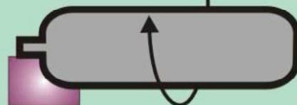
flutournage : la pièce est déformée par application sur un mandrin tournant.
