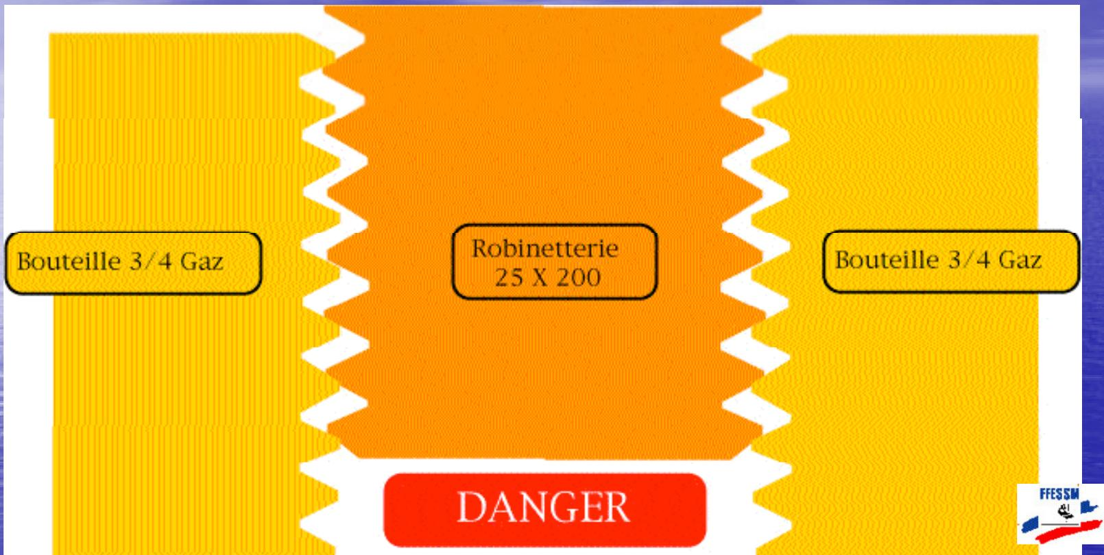
Position d'un robinet 25 X 200 dans une bouteille avec filetage 3/4 gaz
